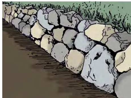
exemples d'encrochement de type cyclopéen proscrits...
