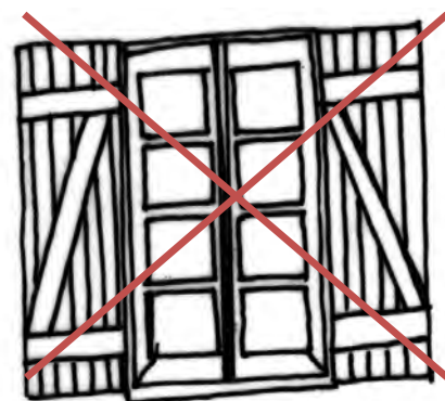
Volets à écharpes ou en « z », proscrits dans l'AVAP
