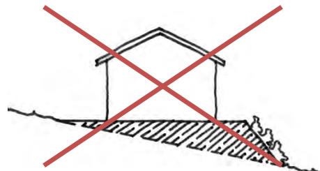
mise à niveau par talutage
